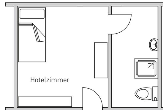
**Beispiel 2:** Für eine Badtür in einem Hotelzimmer empfiehlt sich der Einsatz einer Feuchtraumtür, da mit erhöhter Luftfeuchtigkeit und gelegentlichem Spritzwasser zu rechnen ist.
