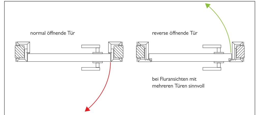
Rot zeigt die Standardtür mit dem nach außen zu öffnenden Türblatt;
