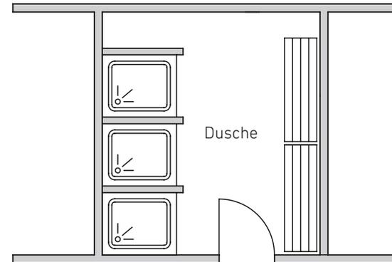
**Beispiel 1:** Eine Tür führt vom Flur in einen Duschaum. In diesem Fall wird der Einsatz einer Nassraumtür empfohlen. Hier ist mit einer sehr hohen Luftfeuchtigkeit und ständigem Spritzwasser zu rechnen.
