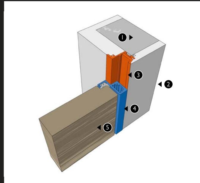
① Mauerwerk ② Putzoberfläche ③ Aluminium-Unterzarge ④ Aluminium-Deckzarge ⑤ 40 mm Türblatt
